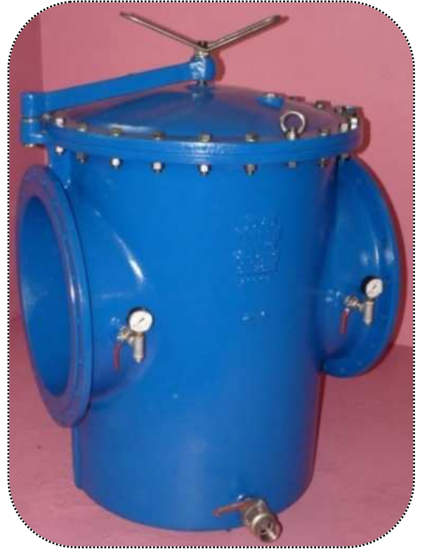
Kapağı açmaya yarayan kol düzeneği
